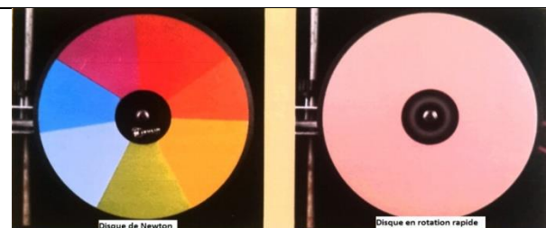
Figure 6 : Reconstitution de la lumière blanche par le disque de Newton
