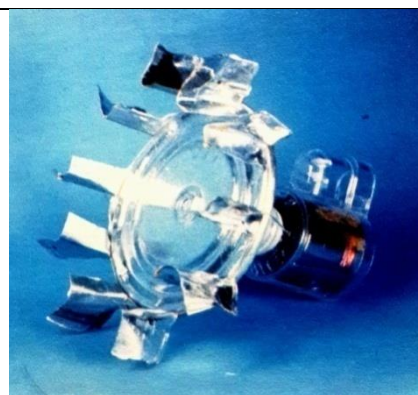
Photo 1 : un alternateur fabriqué avec du matériel de récupération
